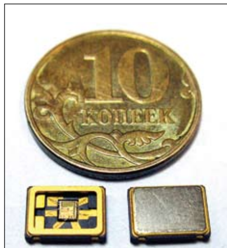
Рис. 1. Применение микросхемы в составе генератора ГК 109-С
