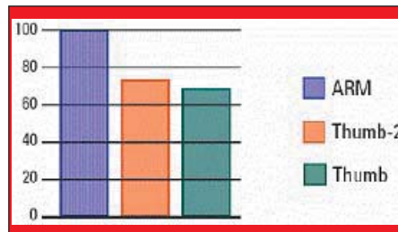
Рис. 6. Код Thumb-2 на 26% меньше кода ARM по результатам тестов Dhrystone
