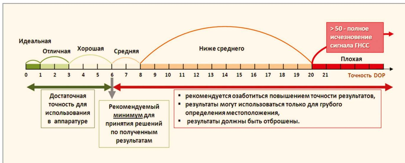
Рис. 8. Линейная шкала изменения фактора ухудшения точности
