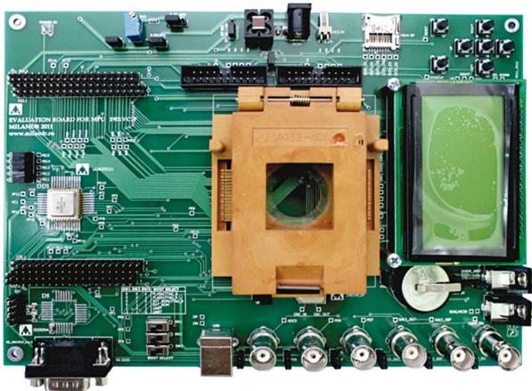
Рис. 2. Демонстрационно-отладочная плата для микроконтроллера 1901BЦ1T
