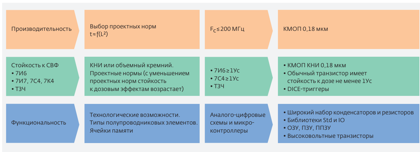
Рис.2. Алгоритм выбора техмаршрута изготовления СБИС
