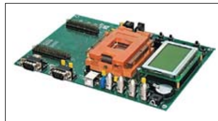
Рис. 1. Внешний вид отладочной платы для МК серии 1986BE9x
