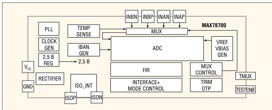
**Рис. 1. Блок-схема MAX78700**
