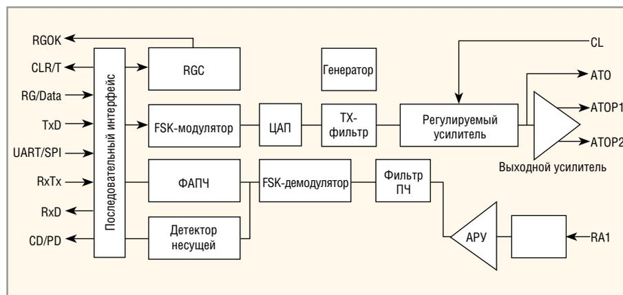
Рис. 3. Структурная схема ST7538/ST7540
