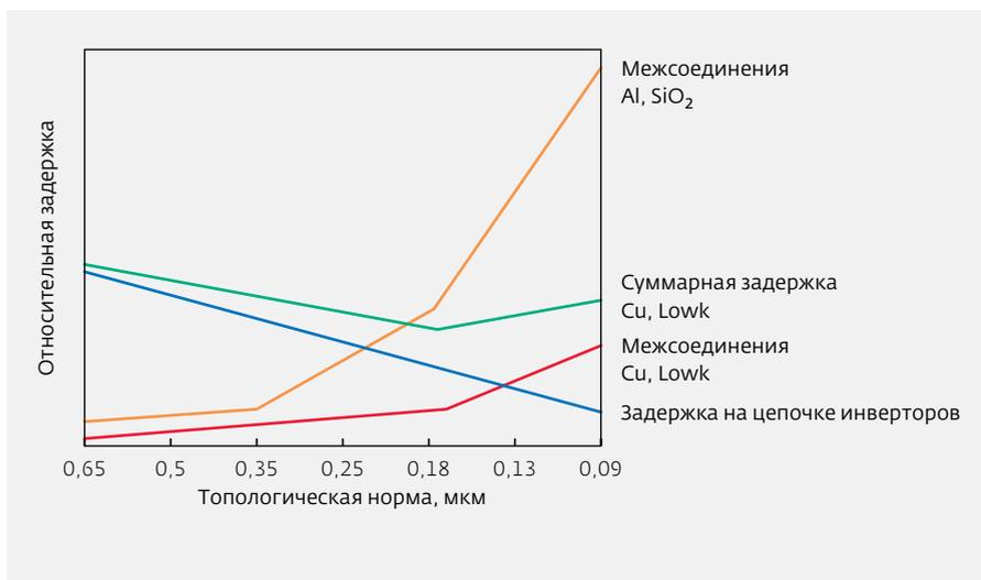
**Рис.5.** Относительное изменение задержек на межсоединениях и цепочках инверторов при уменьшении топологических норм. Al, SiO<sub>2</sub> – в качестве межсоединений (разводки) используется алюминий (Al), а в качестве диэлектрика – окисел кремния (SiO<sub>2</sub>); Cu, Lowk – в качестве межсоединений (разводки) используется медь (Cu), а в качестве диэлектрика – диэлектрик с низкой удельной диэлектрической проницаемостью (конфиденциальная информация каждой фабрики)
