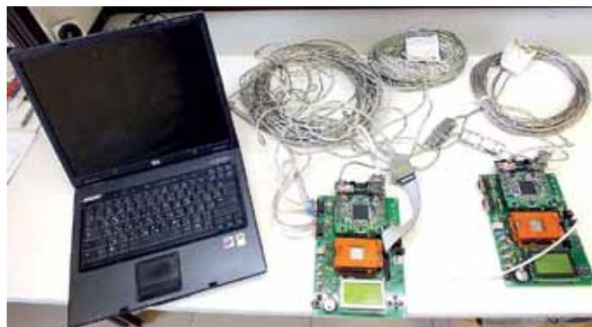
**Рис.8.** ПЛИС-реализация СВП с отладочной платой 1986ВЕ91
