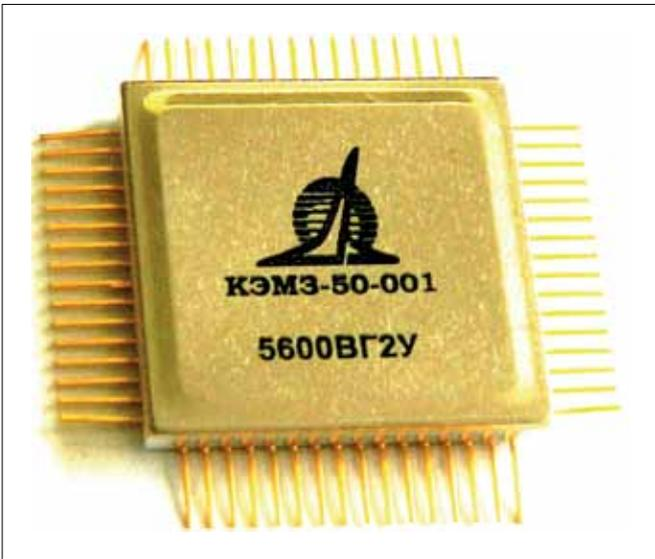
Рис.9. Микросхема K5600BG2U
