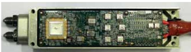
**Рис.7.** Управляющий модуль распределенной системы управления
