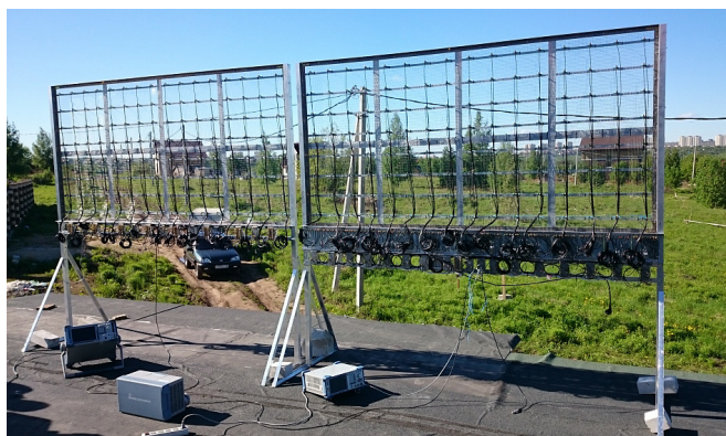
Рис. 1. Приемная и передающая решетки радиолокационной станции
