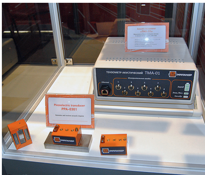
Компоненты системы тензометрического контроля состояния металлоконструкций
