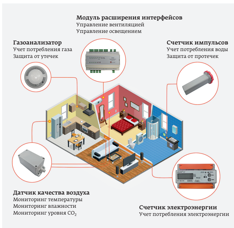
Рис. 3. Устройства системы АСКУЭ
