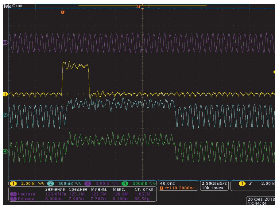
Рис. 6. Осциллограмма процесса синхронизации двух независимых тактовых разветвителей
