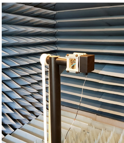
Рис. 6. Измерение диаграммы направленности однолучевого радара в безэховой камере
