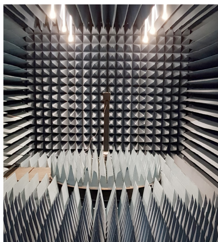
Рис. 6. Измерение диаграммы направленности однолучевого радара в безэховой камере
